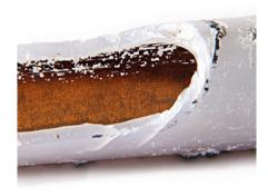
I tubi del riscaldamento a pavimento installati tra il 1970 e il 1990 sono solitamente realizzati in semplice plastica e, nel corso degli anni, diventano fragili e incrostati a causa di fattori esterni. Se questo è il vostro caso e se il risanamento secondo l'HAT-System è ancora fattibile, lo si può determinare tramite un'analisi completa e affidabile della situazione.
