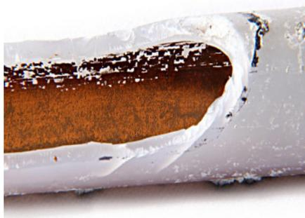
Les conduites de chauffage au sol installées dans les années 1970 à 1990 sont généralement composées de plastique simple qui se fragilise et s'encrasse au fil des ans et du fait de facteurs externes. Une analyse complète et sérieuse de l'état permettra de déterminer si votre système est concerné et si un assainissement par le HAT-System est possible.
