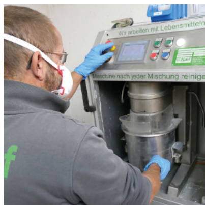
Remplissage du mélangeur-doseur
