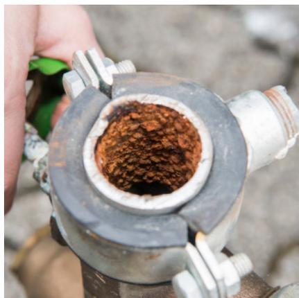
potabile dall'interno e analizza tutti i parametri rilevanti relativi all'acqua potabile. In base al tipo di edificio viene eseguita un'analisi endoscopica e vengono prelevati campioni di tubi, che successivamente vengono analizzati internamente da parte del Naef GROUP per stabilire il tipo di intervento necessario.
