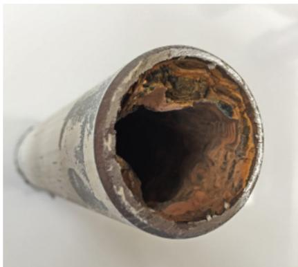
Tubo corrosivo e incrostato
